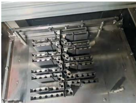
Шаблон (оснастка) под печатную плату для паяльного модуля Pro-M46
