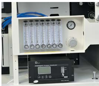
Датчики давления и потребления азота и анализатор кислорода (для азотных печей AR)
