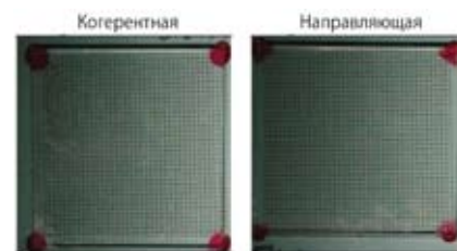
Рис. 8. Сравнение результатов отмывки с помощью когерентной и направляющей насадок (безотмывный флюс, время отмывки 10 мин)
