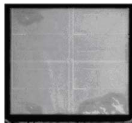
Рис. 2. Остаток флюса под кристаллом способствует увеличению пустот
