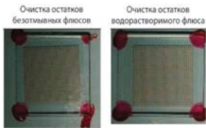
Рис. 4. Сравнение результатов отмывки флюса
