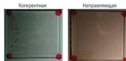
Рис. 6. Сравнение результатов отмывки с помощью когерентной и направляющей насадок (безотмывный флюс, время отмывки 4 мин)
