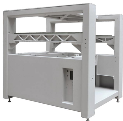
Рис. 2. Сварная станина автомата AUTOTRONIK
