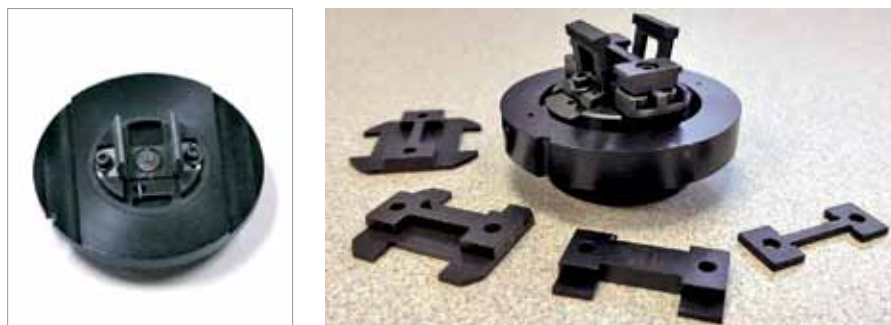
Рис.5. Захват "гриппер" под один тип компонента (слева); захват "гриппер" с комплектом сменного инструмента для различных видов нестандартных компонентов
