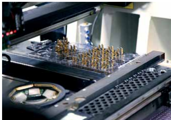
Рис.3. Монтаж компонентов сложной формы: вакуумный захват и компонент, для которого он предназначен – коннектор особой формы (слева; линейка проградуирована в дюймах); лоток-питатель, разработанный компанией для данного компонента, в левом углу на переднем плане – телекамера для распознавания Magellan (справа)
