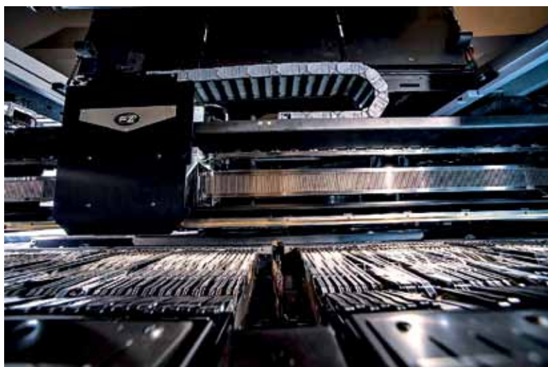
Рис.7. Неподвижная стальная балка является статором линейного мотора VRM (слева); с тыльной, по отношению к голове, стороны хорошо видны подвижные части VRM – каретки с индукционными катушками, выполняющими функцию его "роторов" (справа)
