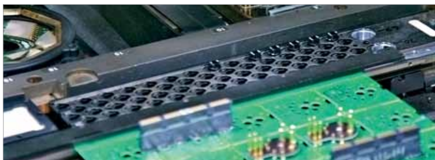
Рис.6. Устройство смены захватов для головы FZ7 на 70 стандартных мест
