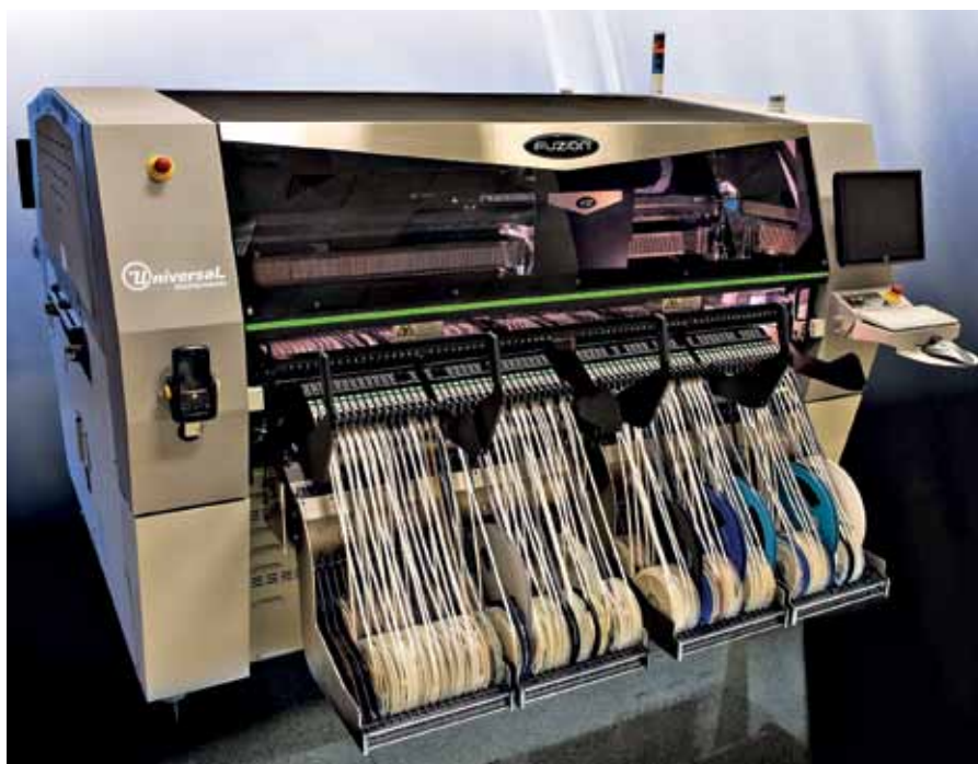
Рис.8. Питатели ion в одной из широкобазных моделей платформы Fuzion. Питатели расположены в четырех базах (в узкобазные модели устанавливается по две базы на каждой стороне автомата), катушки разного диаметра помещены в корзины баз
