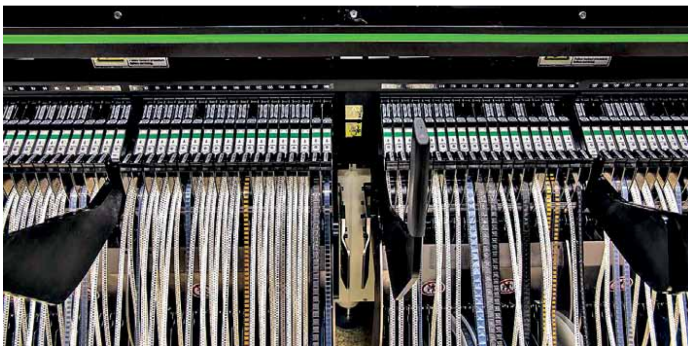
Рис.9. Питатели ion. Хорошо видны 8-, 12- и 16-мм ленты, а также возможность использовать для 8-мм ленты лишь один из двух каналов питателя
