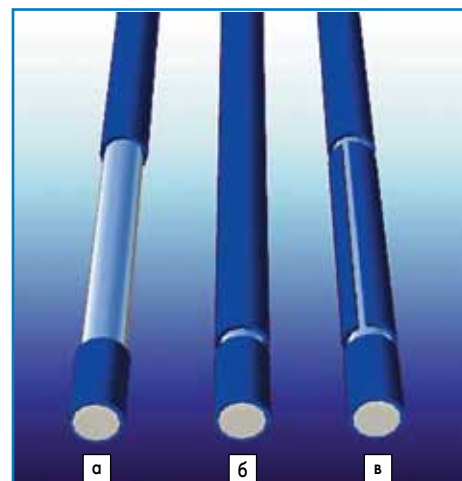
Рис. 2. Схема, показывающая различные геометрические конфигурации снятия изоляции: а) окно с удаленной из окна изоляцией; б) поперечный разрез; в) окно
