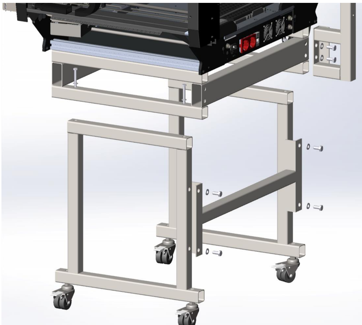
Рисунок С. 2 – Места соединений деталей технологического стола
