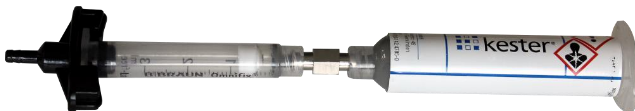
Рисунок 3.27 – Заправка шприца пастой с помощью переходника
