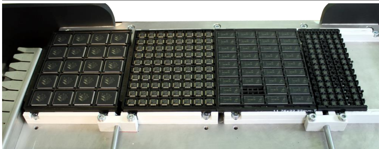
Рисунок 3.4 – Использование частей поддонов произвольной длины
