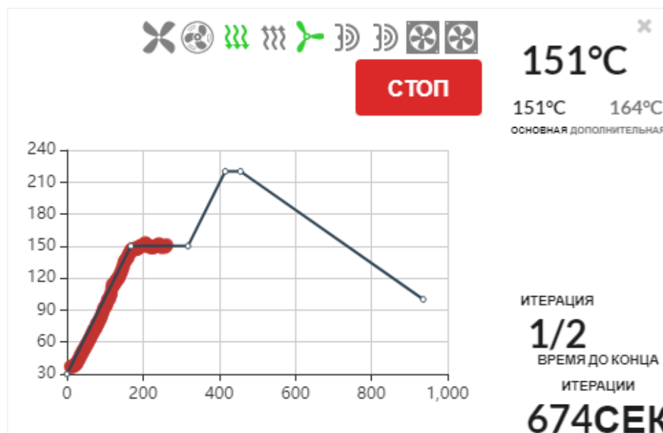
Рисунок 3.7 – Процесс работы печи по заданному термопрофилю
