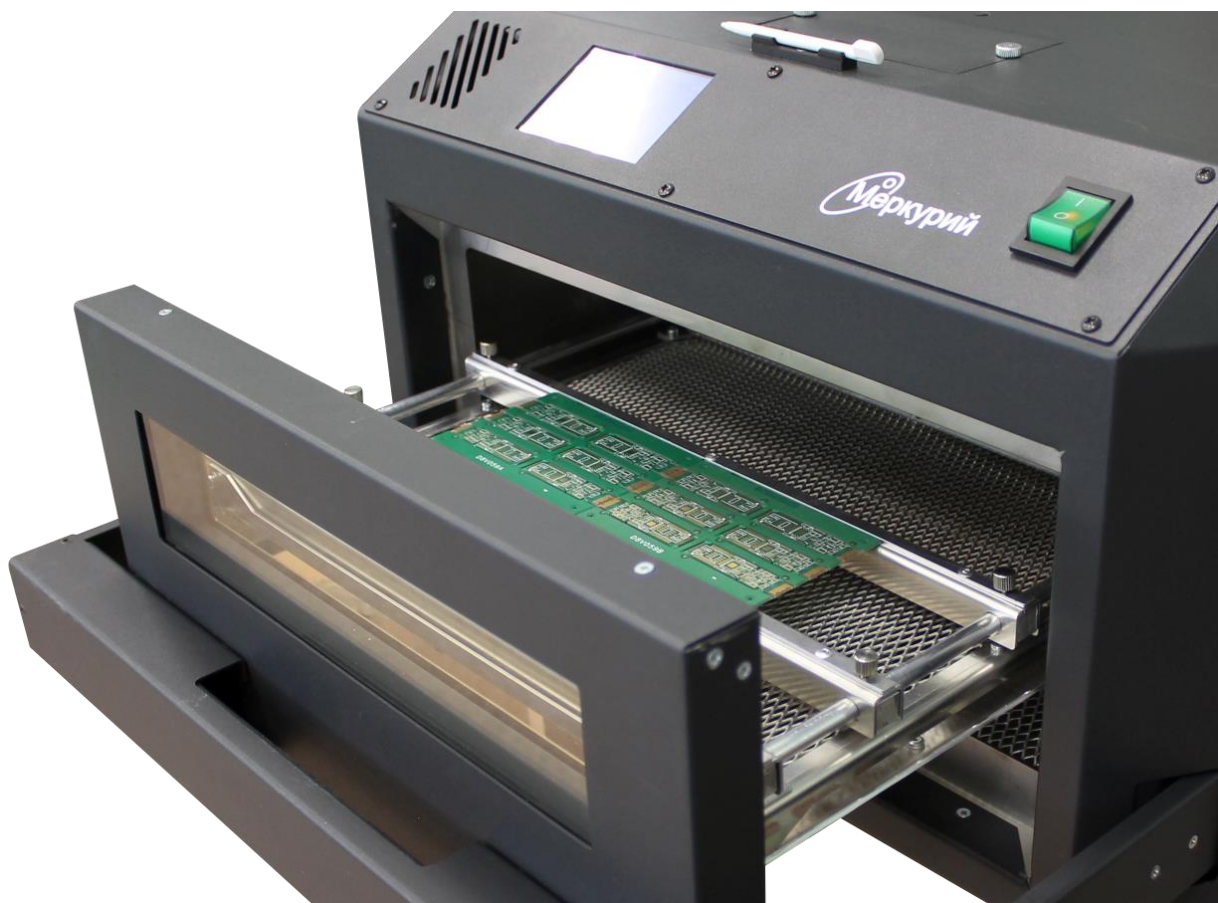
Рисунок 3.1 – Выдвижная полка с направляющими для печатных плат
