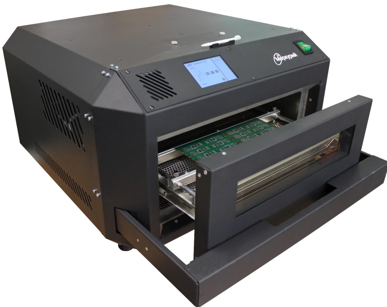
Рисунок 1.1 – Общий вид Конвекционной печи оплавления Меркурий
