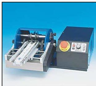
**TP6 с приводом MOT98 и фидером CS10**
